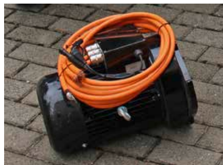
Das schwarze Aggregat ist der Elektromotor, der direkt an das alte Trabi-Getriebe angeschraubt wird.
